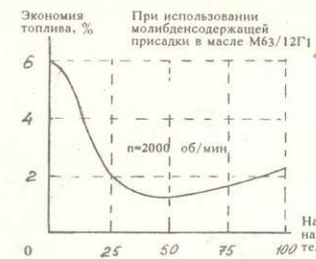
Рис. 2. Экономия топлива от нагрузки двигателя при использовании добавки к моторному маслу.
